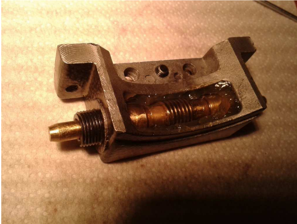
Apretar con una llave de pico de loro cubriendo la rosca con un trapo para no dañarla
