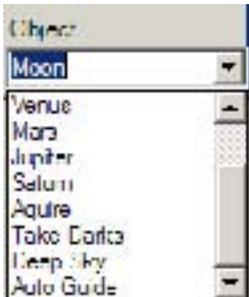
Al seleccionar un tipo de objeto, el programa ajusta automáticamente los valores de *Gain* y *Offset* mas adecuados para ese tipo de objeto, aunque finalmente suele ser necesario aplicar el autoajuste antes descrito. Al mismo tiempo, el programa inserta el nombre seleccionado en *Object Name*, que se usa para denominar los ficheros donde se guardarán las imágenes.
