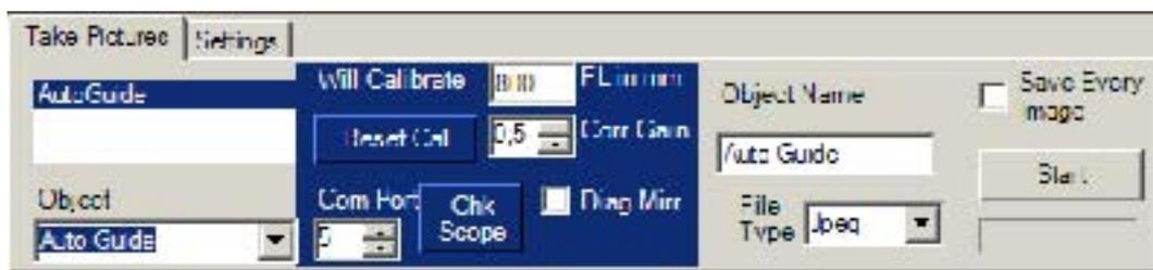
el ordenador moverá el telescopio para no perder el objeto seleccionado. Para ello es preciso tener conectado el cable serie del PC al mando de control *Autostar* del telescopio, y haber seleccionado el puerto de comunicaciones del PC al que está conectado el cable serie.
